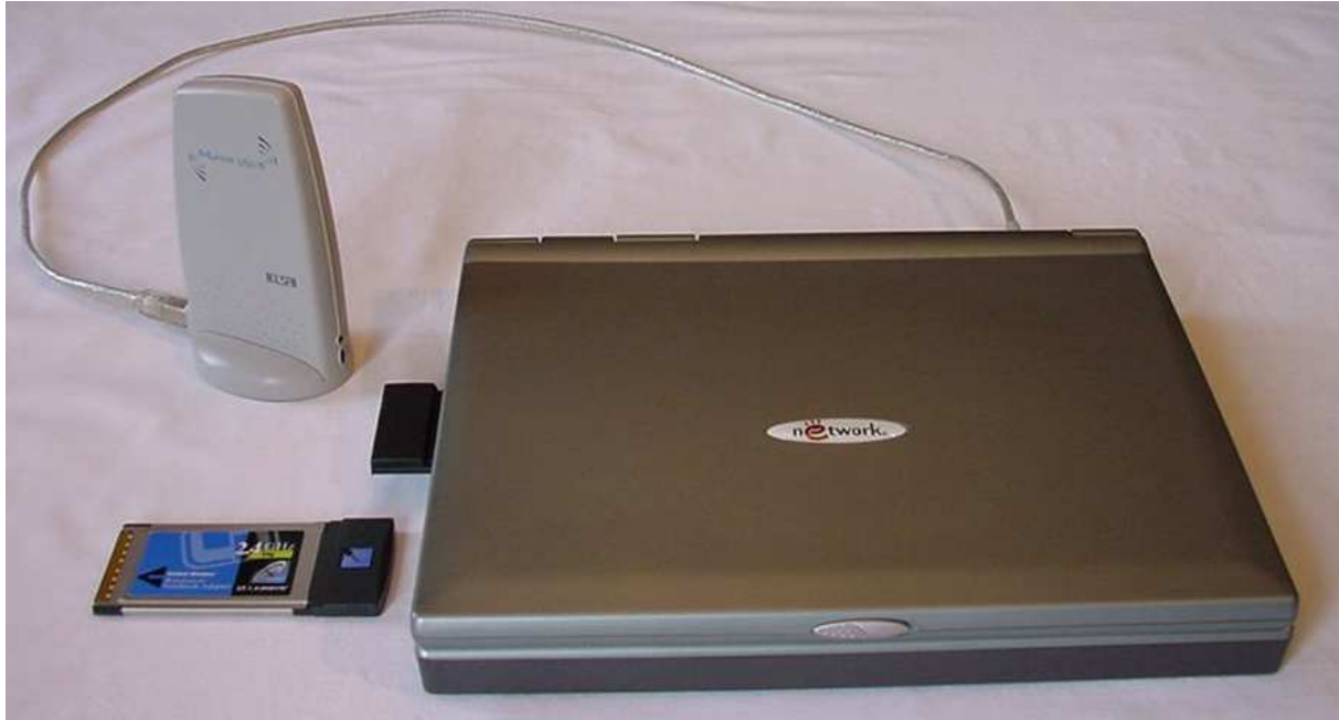
Abb. 3: Beispiele für WLAN PC-Cards (vorne links und seitlich im Notebook) sowie WLAN USB-Terminal-Adapter (hinten)
