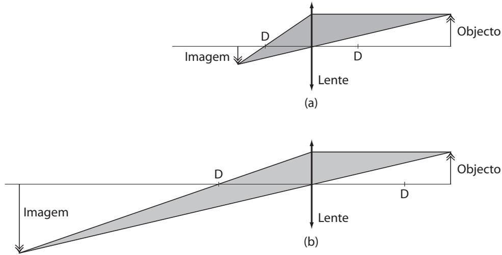
Figura 1: Formação de uma imagem com duas lentes do mesmo diâmetro, mas de distâncias focais diferentes. A distância focal  $D$  da lente de cima é metade da distância focal da lente de baixo, o que significa que, com a mesma quantidade de luz (a área a sombreado), a imagem formada pela lente de cima tem metade da área da formada pela lente de baixo.
