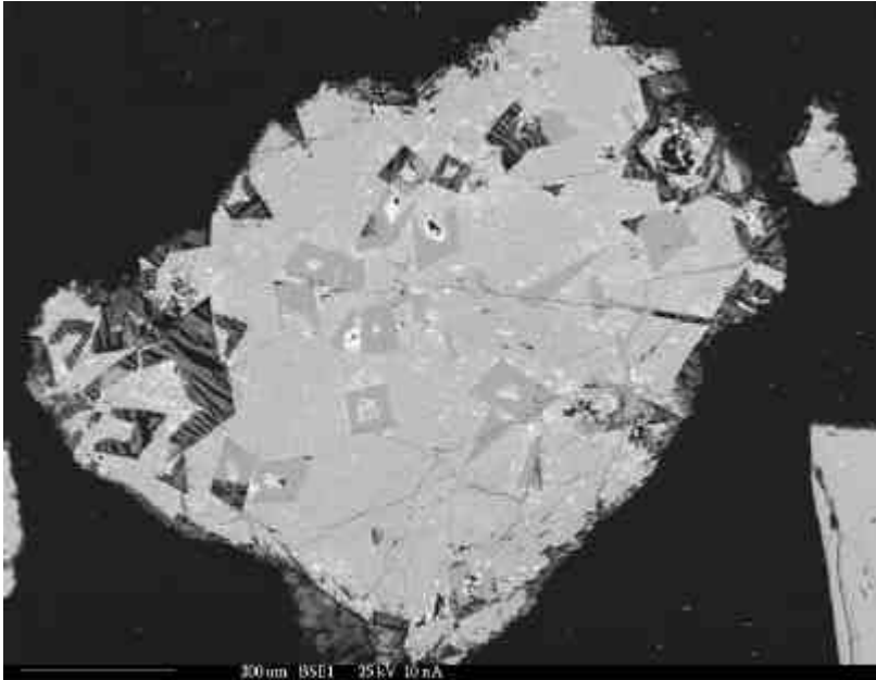
Abb. 79: Die gleichen Verwitterungsstrukturen wie bei Abb. 78. An den Rändern der verwitterten Primärminerale entstehen als Pseudomorphose Sekundärminerale mit einer anderen Zusammensetzung (Erklärung s. S. 161 f).
