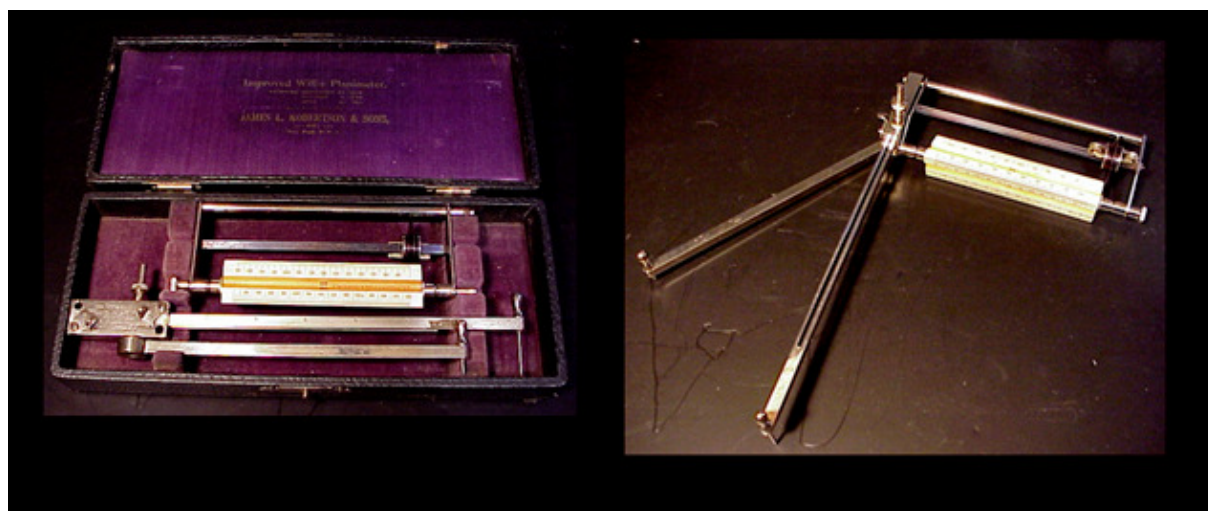
7. ábra Javított Willis-féle poláris planiméter a hordozótáskájában, valamint összeszerelt állapotban. Ez a készülék különböző léptékű térképekhez készült, forgatható skálával van ellátva, a területet a megfelelő skálán egy hosszú csiga által mozgatott mutató segítségével lehet leolvasni.
