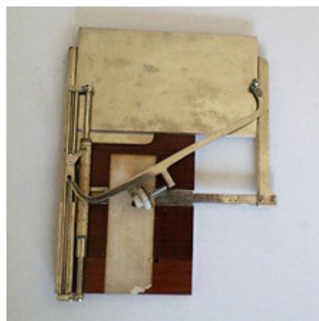
5. ábra balra: A lineáris planiméterek szerkezeti elve, jobbra: Bushnell, 1903-ban gyártott lineáris planimétere
