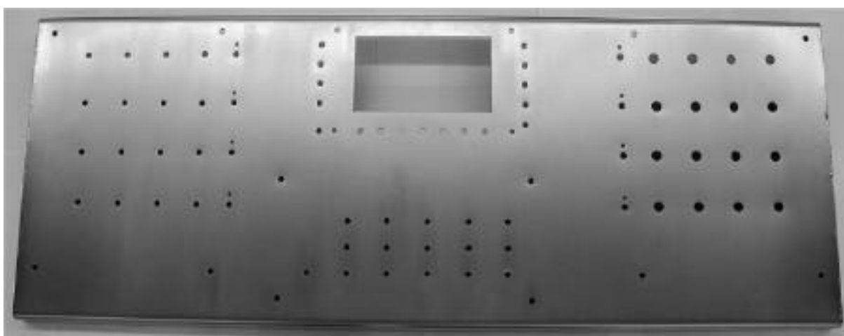
Kabinett for montering av potmetere, knapper og display.
