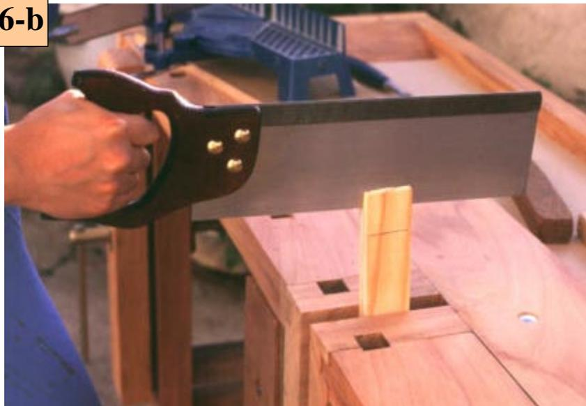
Prenda a **Travessa** na **Bancada**, conforme visto na **Figura 6-b** e remova o restante. Corte um pouco além da linha e retire o excesso com a **Grosa**.
