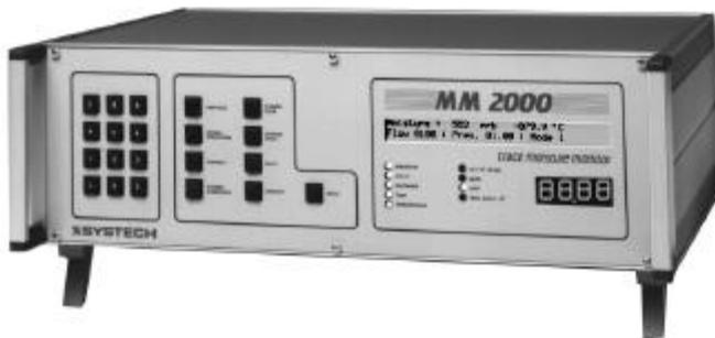
Principios de medida: óxido de circonio, célula electroquímica, célula Hersch, infrarrojos, célula electrolítica (Pentóxido de fósforo), termoconductividad.
