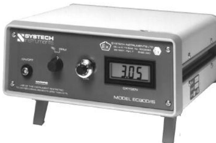
El analizador SYSTECH modelo EC90DIS puede detectar niveles de oxígeno desde 0.1 ppm hasta altos niveles en porcentaje. Puede usarse con la mayoría de los gases industriales y de atmósferas. No se necesita una rutina de mantenimiento en su célula electroquímica (fuel cell), el instrumento se puede calibrar usando aire ambiente o una botella de composición conocida. La lectura no depende del caudal por lo que no se necesita sistema de toma de muestras.
